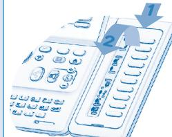
Ihr Apparat kann mit einem Erweiterungsmodul versehen werden. Er verfügt damit über zusätzliche als Funktionstasten, Leitungstasten, Kurzwahltaстen konfigurierbare Tasten usw.
